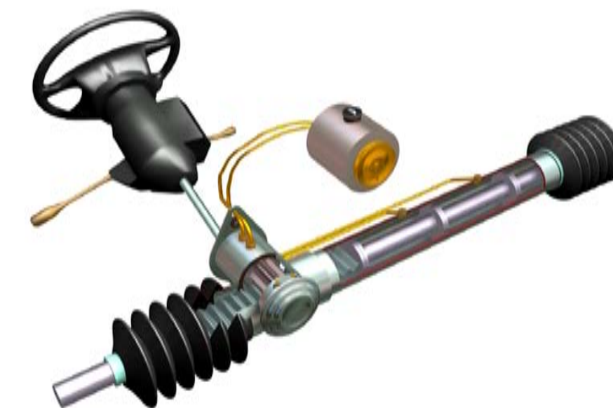
Servo-Lenkanlage mit Lenksäule, Lenkwelle und Lenkhebel
