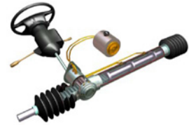
Seitenlenkknäuel mit Lenkhülse, Lenkgetriebe und Lenkhülse
