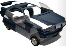
Karosserie und Rahmen bilden ein selbsttragendes Gerüst
