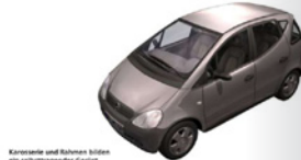
Karosserie und Rahmen bilden ein selbsttragendes Gerüst
